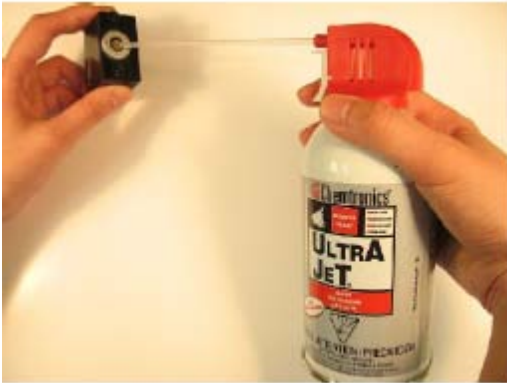
Reinigung Ihres weiblichen Fischer- Steckers mit einem Druckluftzerstäuber
